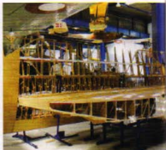
Einfacher Durchblick: Um die Sicht ins Innere der Konstruktion zu ermöglichen, ist eine Seite eines der Schwimmer zum Teil mit einer Plexiglasabdeckung versehen
